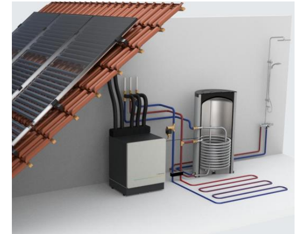
Figuur 8: Voorbeeld water-water warmtepomp gekoppeld aan een PVT-systeem in de woning, inclusief klein buffervat 2 .
