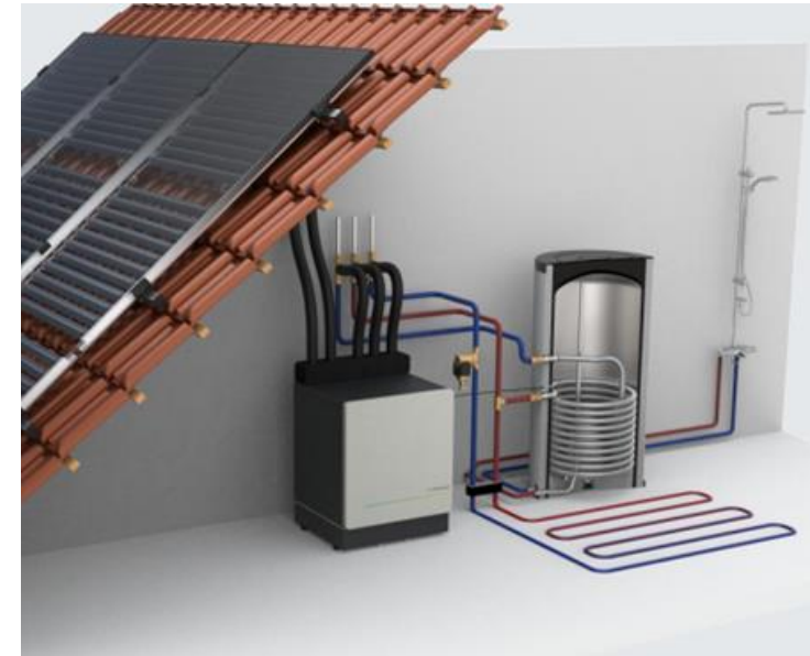
Figuur 16. PVT systeem op de zolderkamer van een woningen direct gekoppeld aan een water-water warmtepomp 2 .
